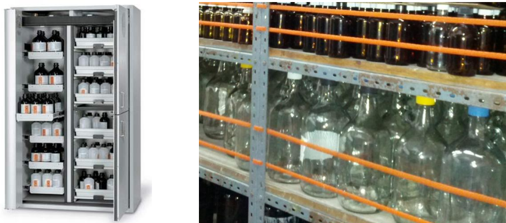
Figura 2. Armario de seguridad para almacenamiento de productos inflamables y corrosivos (izquierda) y estantería para productos químicos en general (derecha).
